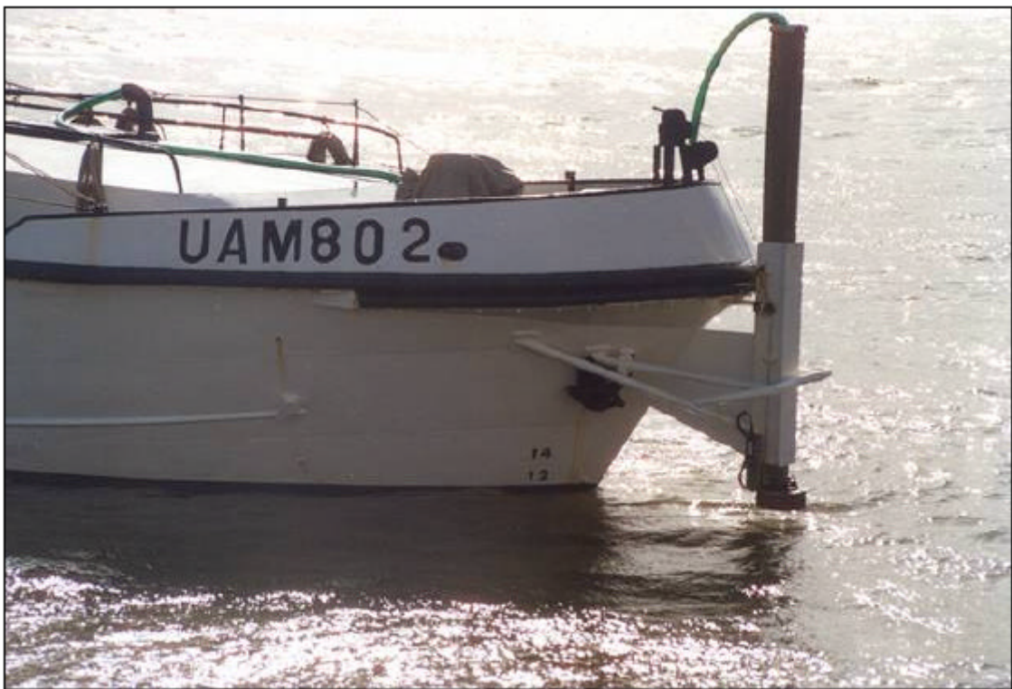
Fig. 3.19 “Instalación del transductor sobre la proa”
